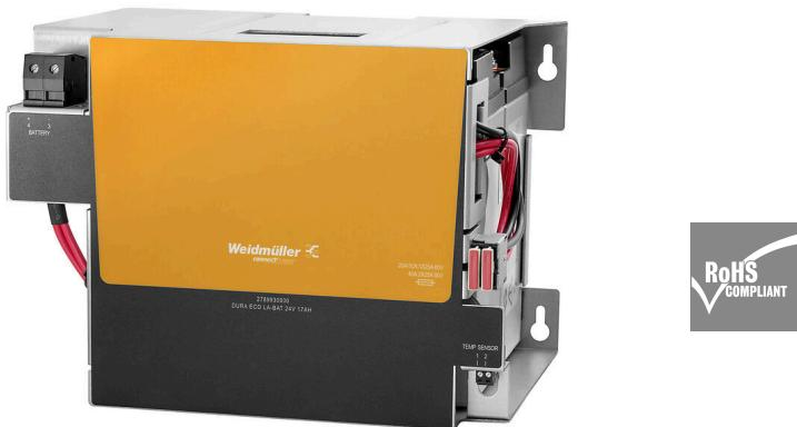
1,2 Ah から 17 Ah までの容量を有する 5 つのバッテリーモジュールは、30 分間に 40 A まで、または 30 時間に 1 A まで供給可能で、DC UPS 制御ユニット CP DC UPS 24V 20A/10A および CP DC UPS 24V 40A と完全な互換性を有します。そして確実に、DURAeco シリーズは、コスト効率の高い形状で柔軟で使いやすいソリューションです。
