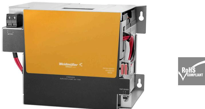
1,2 Ah から 17 Ah までの容量を有する 5 つのバッテリーモジュールは、30 分間に 40 A まで、または 30 時間に 1 A まで供給可能で、DC UPS 制御ユニット CP DC UPS 24V 20A/10A および CP DC UPS 24V 40A と完全な互換性を有します。そして確実に、DURAeco シリーズは、コスト効率の高い形状で柔軟で使いやすいソリューションです。
