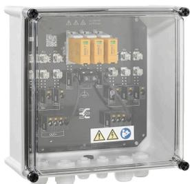
PV Next 発電機端子箱は、1 ~ 12 個の MPP トラッカー搭載インバーター向けに、太陽光発電システムの DC 側を保護するために使用されます。発電機端子箱は過電圧からインバーターを保護するため、欧州指令 CLC/TS 51643-32 に準拠しています。さらに、これらの製品は逆電流からシステムを保護したり、設置中にケーブルを保護するためにストリングスを統合する場合があります。
