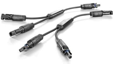
Yケーブルは、PVシステム内の複数のストリングを並列接続するために使用されます。たとえば、インバーターの表側でラインを分割するために使用されます。ケーブルは、さまざまな接続バリエーションで使用できます。
