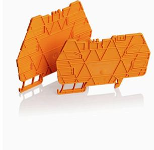
汎用性の高い分離プレートより良好な全体状況のために、分離プレートは、視覚的に信号をまとめたり、モジュールを電氣的に絶縁したり、マーキングを挿入するように使用されます。これにより、それらは特に汎用性の高いアクセサリとなります。分離プレートにより、2つのモジュール間の空気パスおよびクリープパスが増加し、2つのモジュール間の定格絶縁電圧が最大600 Vに増加します。二重分離プレートには WAD5 または WS10/5 マーカーを表示し、継続的な渡り配線を可能にします。渡り配線チャンネルを個別に分割するための通気孔により、設置が容易になります。
