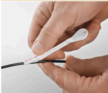
スリムフィックスは、省スペース設計のハロゲンフリーケーブルマーカーです。導体取り付け後でも、マークを取り付けることができます。それらはハロゲンフリー材質から構成され、可燃性等級 V0/V2 に準拠します。SlimFix は、交通技術アプリケーション対応の、認定および認証取得済マークの種類です。SF ツールを使用すれば、小型マークでも簡単に設置できます。
