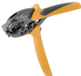
絶縁材を剥ぎ取った後、ケーブル端部に最適な接点またはフェルール端子をクリンプできます。クリンプは、導体と接点との間に安全な接続を形成し、今では概ねはんだ付けに取って代わっています。クリンプは、導体と接続エレメントの間に均一で永続的な接続作成を示します。高品質の精密ツールを使わなければ、その接続を作成できません。その結果、機械的、電気的な両方の条件で安全で信頼性の高い接続が得られます。ワイドミュラーは、さまざまな機械クリンプツールを提供しています。リリース機構搭載の統合ラケットは、最適なクリンプを保証します。ワイドミュラーの工具で作られたクリンプ接続は、国際規格や規制に準拠しています。
