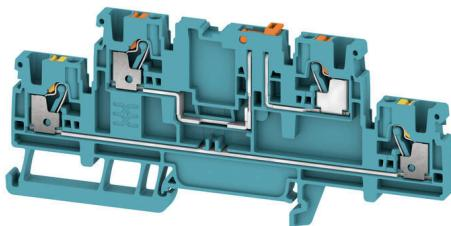
一部の用途では、テストや安全の目的で、テストポイントまたは断路要素をフィードスルー端子に追加することが妥当です。テスト断路端子を使用すれば、無電圧状態で電流回路を測定できます。断路中、空気パスおよびクリープパスの寸法は評価されませんが、指定の定格突入電圧の強度を確認する必要があります。
