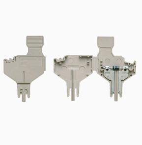
コンポーネントプラグは、電子コンポーネントを接続断路端子台に統合するために使用されます。電子コンポーネントのはんだ付け後、プラグを接続断路端子台の断路箇所に組み込むことで、断路端子台を電子コンポーネント内蔵型のモジューラー端子台に変更します。
