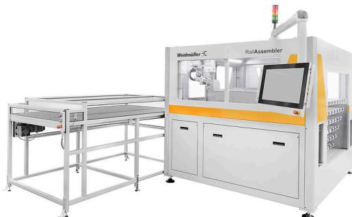
Klippon® Automated RailAssembler で端子台の組立を全自動化できます。自動化されたシステムは、ワイドミュラーコンフィグレータ (WMC) と組み合わせて使用することで、生産プロセスで個々の端子台を選択、割り当て、配置する必要がなくなります。このようにして、通常のアセンブリで最大60 %時間が節約されます。無人運転では、その価値がはさらに重要になります。
