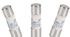
gPV 円筒型ヒューズカートリッジは、最大電圧 1,500 DC までの太陽光発電モジュールの保護（フィールド保護）を小型かつ安全で経済的に実現するために設計されています。これらは、過負荷と短絡の両方に対する保護を提供します（IEC60269-6 および UL248-19 規格準拠 GPV クラス）。内部圧力と熱衝撃に優れたセラミック製チューブで製造され、狭いスペースでも高いスイッチング容量を発揮します。接点は銀メッキ加工銅と純銀の可溶性元素で構成され、経年劣化を防ぎ、電気的特性を不变に保ちます。それらのサイズは 10 x 38 mm、10 x 85 mm、22 x 58 mm がご利用いただけます。
