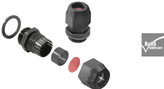
Ex e (安全増防爆) や Ex i (本質安全防爆) の爆発危険場所での使用に適したポリアミド性電線貫通物。 Weidmüller は、制限なしで製品シリーズを提供し、規格への適合に加えて、4/7 Joule の耐衝撃性の向上、および制限なしの -60 °C までの許容温度範囲により、電線貫通金物は優れた性能を有します。それらは、電流標準および EN 60079-0 指令に準拠してテストされ、ATEX および IECEx 認証を取得しています。
