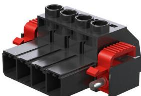
実績の豊富な 100 % メンテナンスフリーのワイドミュラーの鋼製クラップヨーク搭載の高性能オス型ヘッダ。極を損なうことなくサイドバイサイドに設置したり、特許取得済みの多機能フランジにより、工具なしで確実かつ迅速にロックすることができます。誤接続を防ぐ嵌合部構造、独自の多様なコーディング、誤配線防止機能により、接続と運用の信頼性を向上。マーキングの最適化。
