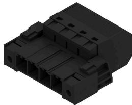
180° 反転ピンヘッダー。7.62 ピッチで 6 mm<sup>2</sup> のフィールド配線対応プッシュイン接続技術採用。エンクロージャーフィードスルー対応の「3 フランジバリエント」。最大壁厚 2 mm のエンクロージャーに適合。逆電圧に対するタッチセーフソリューションとしても最適です。UL1059 600 V クラス C および IEC 61800-5-1 の要件を満たします。
