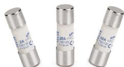
gPV 円筒型ヒューズカートリッジは、最大電圧 1,500 DC までの太陽光発電モジュールの保護 (フィールド保護) を小型かつ安全で経済的に実現するために設計されています。これらは、過負荷と短絡の両方に対する保護を提供します (IEC60269-6 および UL248-19 規格準拠 GPV クラス)。内部圧力と熱衝撃に優れたセラミック製チューブで製造され、狭いスペースでも高いスイッチング容量を発揮します。接点は銀メッキ加工銅と純銀の可溶性元素で構成され、経年劣化を防ぎ、電気的特性を不变に保ちます。これらのサイズは 10 x 38 mm、10 x 85 mm、22 x 58 mm がご利用いただけます。
