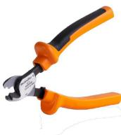
最大外径 8 mm、12 mm、14 mm、22 mm の導体対応カットツール。特殊形状の刃を使用すると、銅およびアルミニウム製の導体を、最小限の物理的な労力とピンチ不使用で切断できます。また切断工具(KT 8 ~ KT 22)には、EN/IEC 60900 に準拠した最大 1,000 V までの VDE および GS でテスト済みの保護絶縁材も付属します。
