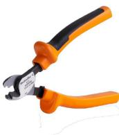
最大外径 8 mm、12 mm、14 mm、22 mm の導体対応カットツール。特殊形状の刃を使用すると、銅およびアルミニウム製の導体を、最小限の物理的な労力とピンチ不使用で切断できます。また切断工具(KT 8 ~ KT 22)には、EN/IEC 60900 に準拠した最大 1,000 V までの VDE および GS でテスト済みの保護絶縁材も付属します。
