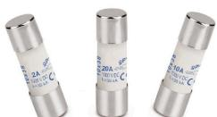
gPV 円筒型ヒューズカートリッジは、最大電圧 1,500 DC までの太陽光発電モジュールの保護（フィールド保護）を小型かつ安全で経済的に実現するために設計されています。これらは、過負荷と短絡の両方に対する保護を提供します（IEC60269-6 および UL248-19 規格準拠 GPV クラス）。内部圧力と熱衝撃に優れたセラミック製チューブで製造され、狭いスペースでも高いスイッチング容量を発揮します。接点は銀メッキ加工銅と純銀の可溶性元素で構成され、経年劣化を防ぎ、電気的特性を不变に保ちます。それらのサイズは 10 x 38 mm、10 x 85 mm、22 x 58 mm がご利用いただけます。
