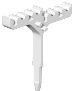
SnapMark - このタグキャリアは、I モデルシリーズの二段端子 IDK 1.5N に対応して特別に開発されています。柔軟なピボット機構は、渡り配線の容易な取り付け、取り外しを可能にします。4 種の DEK 5 ラベリングタグ、または 2 種の WS 10/5 Middle コネクタマーカーを保持できます。
