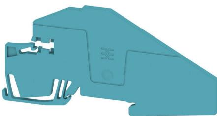
分離プレートとエンドプレートは端子台にとって不可欠なアクセサリです。分離プレートは、異なる電位や機能グループを光学的および電気的に分離し、安全性を高め、制御盤内部の構造を明確にします。エンドプレートは端子台列の側面を閉じ、通電部分との接触を防ぎ、清潔で安定した仕上がりを確保します。どちらのコンポーネントも、それぞれのWeidmüller端子台シリーズに正確に適合しており、安全でコンプライアンスに準拠したプロフェッショナルな配線に役立ちます。
