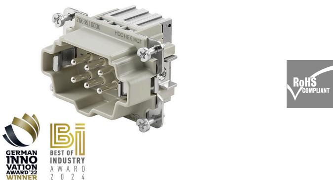
SNAP IN接続では、導体接続レベルは既に開いており、取り外したコネクタを簡単に挿入できます。最終位置では、特許取得済のクランプ機構が自動的に閉じます。その結果、メンテナンスが実質的に不要となり、安全で永久的で振動耐性を有する接続が確立されます。ワイドミュラーは、この革新的な接続システムを提供した最初で唯一のメーカーです。
