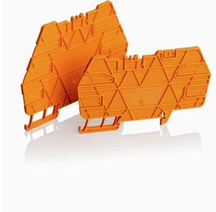
汎用性の高い分離プレートより良好な全体状況のために、分離プレートは、視覚的に信号をまとめたり、モジュールを電氣的に絶縁したり、マーキングを挿入するように使用されます。これにより、それらは特に汎用性の高いアクセサリとなります。分離プレートにより、2つのモジュール間の空気パスおよびクリープパスが増加し、2つのモジュール間の定格絶縁電圧が最大600 Vに増加します。二重分離プレートには WAD5 または WS10/5 マーカーを表示し、継続的な渡り配線を可能にします。渡り配線チャンネルを個別に分割するための通気孔により、設置が容易になります。
