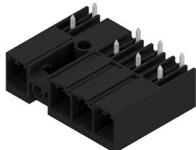
7.62 ピッチのミドルフランジ付属 270° オス型ヘッダー。IEC 61800-5-1 の要件を満たし、UL840 600 V に準拠して UL 認証取得が可能です。メス側ヘッダーがない場合、接合プロファイルは、テストフィンガーに 20 N 以上の圧力を 3 mm 以上のを保証。オプションでネジ止めも可能なミドルフランジの自動ロック機能により、従来のソリューションと比較して、必要なスペースを 1 ピッチ幅に削減できます。ご要望に応じて、ネジフランジ付属またはフランジなしの型でご利用になれます。
