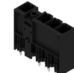
7.62 ピッチのミドルフランジ付属 180° オス型ヘッダー。IEC 61800-5-1 の要件を満たし、UL840 600 V に準拠した UL 認証を取得します。メス側ヘッダーなしの場合、接合プロファイルにより、テストフィンガーに 20 N の圧力をかけた状態で 3 mm を超える接触安全性が保証されます。オプションでネジ固定も可能なミドルフランジのセルフロックにより、従来のソリューションと比較して、必要なスペースを 1 ピッチ幅に削減できます。ご要望に応じて、ネジフランジ付き、またはフランジなしでご利用になれます。
