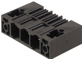
単列、高電流オス型ヘッダーは電極を犠牲にすることなく整列状態に取り付けることができます。また、ツール不使用ですばやくロックするための特許取得済みのフランジが付属します。接合プロファイルにより、固有に識別可能なコーディング多様性およびフランジへの追加締め付けにより、誤接を防止し、接続性と動作信頼性が最大限に向上します。3.5mm 長のピンは、フローはんだ付けに対して最適化され、プラグイン方向は、はんだ付けピンに対して 90° です。
