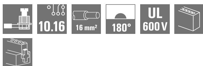
IT ネットワーク対応 10.16 ピッチの 180° メス側プラグ。UL1059 600 V クラス C の要件を満たしています。リーディングコントタクトを備えたオス型ヘッダ SU 10.16 IT との組み合わせで IEC 61800-5-1 による IT パワーネットワークにおける 5.5 mm タッチセーフティの拡張要件を満たしており、アース接続 400 V に対応します。セルフロック式の（オプションでねじ締めも可能）ミドルフランジにより、両サイドに固定具のある方式にくらべ 1 極分の省スペース化を実現します。またオプションで、ミドルフランジなしタイプもご用意しています。
