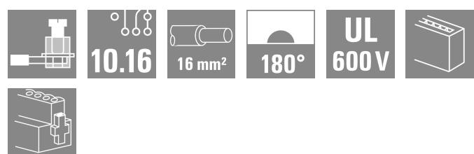
IT ネットワーク対応 10.16 ピッチの 180° メス側プラグ。UL1059 600 V クラス C の要件を満たしています。リーディングコントラクトを備えたオス型ヘッダ SU 10.16 IT との組み合わせで IEC 61800-5-1 による IT パワーネットワークにおける 5.5 mm タッチセーフティの拡張要件を満たしており、アース接続 400 V に対応します。セルフロック式の（オプションでねじ締めも可能）ミドルフランジにより、両サイドに固定具のある方式にくらべ 1 極分の省スペース化を実現します。またオプションで、ミドルフランジなしタイプもご用意しています。
