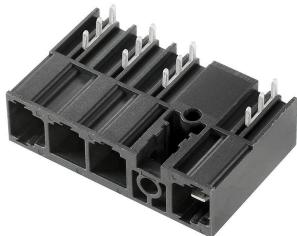
IEC 61800-5-1 に準拠した 400V IT システム対応の、10.16 ピッチはんだ付けミドルフランジ固定付きオス型ヘッダ。UL840 (600 V) に準拠した UL 認可を取得しています。BUZ 10.16 IT と共に使用する場合、IEC 61800-5-1 に準拠して、IT システムによる 5.5mm の接触保護 (接地に対して 400 V) の拡張要件に準拠しています。ミドルフランジインターロック機能は、他の標準ソリューションと比較して、1ピッチ幅で必要なスペースを減少させます。ご要望に応じて、ネジフランジ付属、またはフランジ無しで使用可能。
