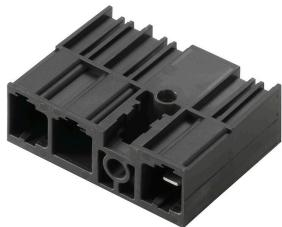
IEC 61800-5-1 に準拠した 400V IT システム対応の、10.16 ピッチはんだ付けミドルフランジ固定付きオス型ヘッダ。UL840 (600 V) に準拠した UL 認可を取得しています。BUZ 10.16 IT と共に使用する場合、IEC 61800-5-1 に準拠して、IT システムによる 5.5mm の接触保護 (接地に対して 400 V) の拡張要件に準拠しています。ミドルフランジインターロック機能は、他の標準ソリューションと比較して、1ピッチ幅で必要なスペースを減少させます。ご要望に応じて、ネジフランジ付属、またはフランジ無しで使用可能。
