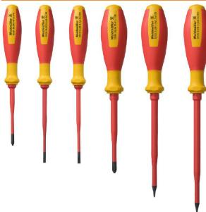
VDE 絶縁ドライバーセット、最大1000 V AC および 1500 V DC の通電部品作業対応、DIN EN 60900。IEC 900.各部品は「GS」の安全検査を受けています。完全硬化の高合金クロームバナジウムモリブデン鋼製ブレード、ガンメタル仕上げ。
