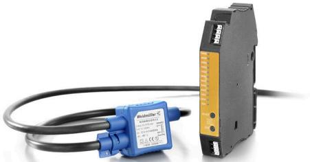
ロゴスキーコイルロゴスキーコイルは、交流およびびパルス電流の浮遊電位測定に用いられる強磁性コアを有さない閉鎖状態の空心コイルです。ロゴスキーコイルを用いた測定は、既存のシステムの一次電流回路を絶縁することなく遡及的に集積できるため、技術的に広く利用されています。この方法は飽和効果を示さないので、最小の電流や高周波高調波でも精度を落とさずに測定できます。
