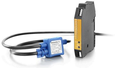
ログスキーコイルログスキーコイルは、交流およびパルス電流の浮遊電位測定に用いられる強磁性コアを有さない閉鎖状態の空心コイルです。ログスキーコイルを用いた測定は、既存のシステムの一次電流回路を絶縁することなく遡及的に集積できるため、技術的に広く利用されています。この方法は飽和効果を示さないため、最小の電流や高周波高調波でも精度を落とさずに測定できます。
