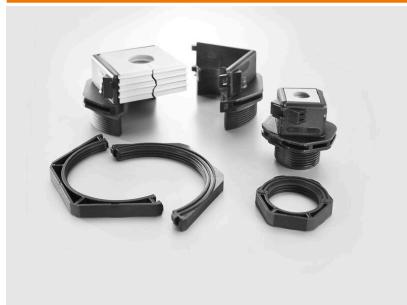
測定基準の M20 から M63 のスルーホール の場合、Cabtite ケーブルエントリシステムは、プラグ付きとプラグなしのケーブル対応の絶縁可能なケーブルグランドを提供します。システムのメンテナンスや変更を行う場合は、直径 2 ~ 35 mm の組立済ケーブルを制御盤やエンクロージャーにすばやく安全に挿入できます。DIN EN 60529 に準拠した IP66 の信頼性の高いシーリングと、ケーブルグランド物の半分のいずれかに挿入する前に、ケーブル周囲に波形カットを施した溝付き封止エレメントを配置することで、確実に固定されたフィッティング (DIN EN 62444 準拠のケーブル負荷解放部品) が保証されます。絶縁可能なシステムは、簡単かつ迅速な設置を実現します。封止エレメント挿入後、ケーブルグランドの2つの半分を共に単純にスナップします。制御盤の内側に、絶縁可能なロックナットを設けることで、信頼性が高く確実な保持が可能です。
