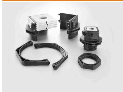
測定基準の M20 から M63 のスルーホール の場合、Cabtite ケーブルエントリシステムは、プラグ付きとプラグなしのケーブル対応の絶縁可能なケーブルグランドを提供します。システムのメンテナンスや変更を行う場合は、直径 2 ~ 35 mm の組立済ケーブルを制御盤やエンクロージャーにすばやく安全に挿入できます。DIN EN 60529 に準拠した IP66 の信頼性の高いシーリングと、ケーブルグランド物の半分のいすれかに挿入する前に、ケーブル周囲に波形カットを施した溝付き封止エレメントを配置することで、確実に固定されたフィッティング (DIN EN 62444 準拠のケーブル負荷解放部品) が保証されます。絶縁可能なシステムは、簡単かつ迅速な設置を実現します。封止エレメント挿入後、ケーブルグランドの2つの半分を共に単純にスナップします。制御盤の内側に、絶縁可能なロックナットを設けることで、信頼性が高く確実な保持が可能です。
