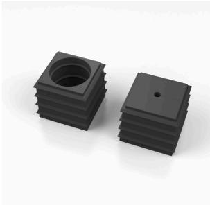
大型、小型のケーブル直径どちらも - Cabtite は常に適切なシールインサートを備えています。シール要素の円錐形状により、以前に配置したスナップイングリッドインレイを内側から外側に簡単に押し込むことができます。DIN EN 62444に準拠し、中間スペースを確実に封止し、ケーブル負荷解放部品を提供します。シールインサートとフレームの組み合わせで、IP 66 の保護等級を達成します。マイナス溝付き形状のため、組立済ケーブルに特に適しています。
