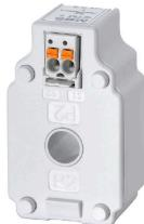
CMA-CTM 7 シリーズ小型電流トランスフォーマーは、円形の一次導体の変流器原理に従って設計された誘導電流トランスフォーマーです。変流器CMA-CTM 7 シリーズはメンテナンスフリーで、32 A ~ 64 A の範囲の一次電流を測定するように設計されています。これは二次側で、最大 1 A の電流に変換されます。小型設計によって、相間距離17.5mmを有する三相サーキットブレーカのアプリケーションに最適です。
