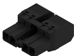
フィールド配線対応プッシュイン接続技術搭載の 180° 逆電圧セーフオス型ヘッダー。6mm<sup>2</sup>、7.62 ピッチフィールド配線対応のセルフロック式ミドルフランジ搭載。また、逆電圧のタッチセーフソリューションとしても最適です。UL1059 600 V クラス C および IEC 61800-5-1 の要件を満たします。ご要望に応じて、ミドルフランジなしでも使用可能です。
