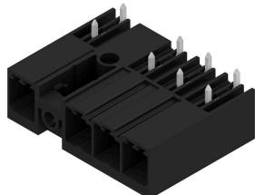
7.62 ピッチのミドルフランジ付属 270° オス型ヘッダー。IEC 61800-5-1 の要件を満たし、UL840 600 V に準拠して UL 認証取得が可能です。メス側ヘッダーがない場合、接合プロファイルは、テストフィンガーに 20 N 以上の圧力を 3 mm 以上のを保証。オプションでネジ止めも可能なミドルフランジの自動ロック機能により、従来のソリューションと比較して、必要なスペースを 1 ピッチ幅に削減できます。ご要望に応じて、ネジフランジ付属またはフランジ無しの型でご利用になれます。
