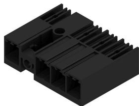
7.62 ピッチのミドルフランジ付属 90° オス型ヘッダー。IEC 61800-5-1 の要件を満たし、UL840 600 V に準拠した UL 認証を取得します。メス側ヘッダーなしの場合、接合プロファイルにより、テストフィンガーに 20 N の圧力をかけた状態で 3 mm を超える接触安全性が保証されます。オプションでネジ固定も可能なミドルフランジのセルフロックにより、従来のソリューションと比較して、必要なスペースを 1 ピッチ幅に削減できます。ご要望に応じて、ネジフランジ付き、またはフランジなしでご利用になれます。
