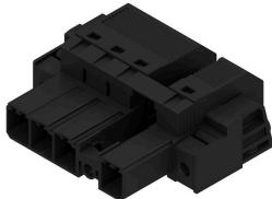
ハウジング通路用の「3 フランジバリアント」 6 mm<sup>2</sup>、7.62 ピッチのフィールド配線対応のプッシュイン接続技術採用の 180° 反転オス型ヘッダー。最大壁厚 16 mm のハウジングに適しています。逆電圧のフィンガーセーフソリューションとしても最適です。UL1059 600 V クラス C および IEC 61800-5-1 の要件を満たします。
