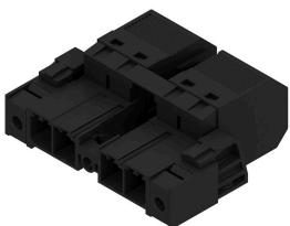
ハウジング通路用の「3 フランジバリアント」 6 mm<sup>2</sup>、7.62 ピッチのフィールド配線対応のプッシュイン接続技術採用の 180° 反転オス型ヘッダー。最大壁厚 2mm のハウジングに取り付け可能です。
