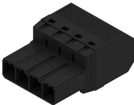
180° 反転ピンヘッダー。7.62 ピッチで 6 mm<sup>2</sup> のフィールド配線対応プッシュイン接続技術採用。エンクロージャーフィードスルー対応の「3 フランジバリエーション」。最大壁厚 2 mm のエンクロージャーに適合。逆電圧に対するタッチセーフソリューションとしても最適です。UL1059 600 V クラス C および IEC 61800-5-1 の要件を満たします。
