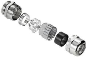
電子部品の感度の向上と電磁干渉周波数の増加により、ケーブルグランドはシステムの外装コンセプトにおいて重要な役割を果たす必要があります。この種別の EMC ケーブルグランドは、360°のスクリーニング接続で、干渉周波数に対する遮蔽を目的に作成されています。フィンガーロックシールは、優れたケーブル保持とケーブル負荷解放部品を提供し、ケーブルグランドは EN 62444 の機械的要件に準拠します。特許取得済形状により、非常に簡単で高速な組み立てが可能になります。
