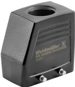
ワイドミュラーの新型RockStar® IP65 EMV エンクロージャは、最も過酷な環境条件での使用に理想的で、電磁波干渉対応の保護を提供します。角型コネクタは、コネクタインサートおよびその保護ハウジングで構成されています。新型プラスチック製ストラップはロックしやすく、随时交換可能です。ワイドミュラー RockStar® のエンクロージャはすべて高品質のアルミニウムダイキャストで製造されています。これにより、耐衝撃性、耐腐食性に優れ、かつ小型化と軽量化を実現しています。
