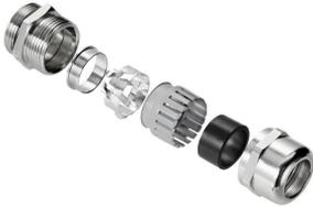
電子部品の感度の向上と電磁干渉周波数の増加により、ケーブルグランドはシステムの外装コンセプトにおいて重要な役割を果たす必要があります。この種別の EMC ケーブルグランドは、360 のスクリーニング接続で、干渉周波数に対する遮蔽を目的に作成されています。フィンガーロックシールは、優れたケーブル保持とケーブル負荷解放部品を提供し、ケーブルグランドは EN 62444 の機械的要件に準拠します。特許取得済形状により、非常に簡単に高速な組み立てが可能になります。
