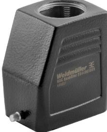
ワイドミュラーの新型RockStar® IP65 EMV エンクロージャは、最も過酷な環境条件での使用に理想的で、電磁波干渉対応の保護を提供します。角型コネクタは、コネクタインサートおよびその保護ハウジングで構成されています。新型プラスチック製ストラップはロックしやすく、随时交換可能です。ワイドミュラー RockStar® のエンクロージャはすべて高品質のアルミニウムダイキャストで製造されています。これにより、耐衝撃性、耐腐食性に優れ、かつ小型化と軽量化を実現しています。
