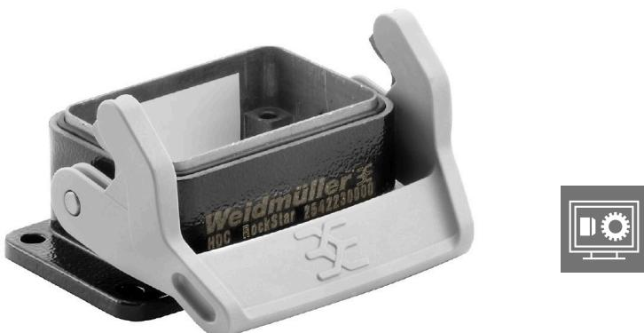
ワイドミュラーの新型RockStar® IP65 EMV エンクロージャは、最も過酷な環境条件での使用に理想的で、電磁波干渉対応の保護を提供します。角型コネクタは、コネクタインサートおよびその保護ハウジングで構成されています。新型プラスチック製ストラップはロックしやすく、随时交換可能です。ワイドミュラー RockStar® のエンクロージャはすべて高品質のアルミニウムダイキャストで製造されています。これにより、耐衝撃性、耐腐食性に優れ、かつ小型化と軽量化を実現しています。
