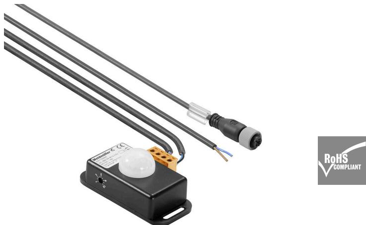
WIL-LED 照明の動作検出器 (ネジ接続付属)、3 m 電源ケーブル、WIL 照明接続対応 M12 ケーブル。切り替え時間を調整可能。
