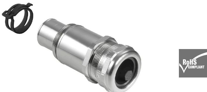
電子部品の感度の向上と電磁干渉周波数の増加により、ケーブルグランドはシステムの外装コンセプトにおいて重要な役割を果たす必要があります。この種別の EMC ケーブルグランドは、360 のスクリーニング接続で、干渉周波数に対する遮蔽を目的に作成されています。フィンガーロックシールは、優れたケーブル保持とケーブル負荷解放部品を提供し、ケーブルグランドは EN 62444 の機械的要件に準拠します。特許取得済形状により、非常に簡単に高速な組み立てが可能になります。
