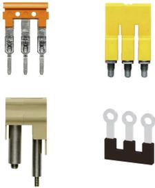
隣接する端子台に対する電位分布または乗算は、渡り配線を介して実現されます。また、追加の配線作業を容易に回避することができます。電極が破損しても、端子台の接触信頼性は確保されます。当社の品揃えは、モジュラー式端子台用の差し込み式でネジ固定可能な渡り配線システムを提供します。
