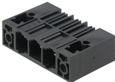
単列、高電流オス型ヘッダーは電極を犠牲にすることなく整列状態に取り付けることができます。また、ツール不使用ですばやくロックするための特許取得済みのフランジが付属します。接合プロファイルにより、固有に識別可能なコーディング多様性およびフランジへの追加締め付けにより、誤接を防止し、接続性と動作信頼性が最大限に向上します。3.5mm 長のピンは、フローはんだ付けに対して最適化され、プラグイン方向は、はんだ付けピンに対して90°です。
