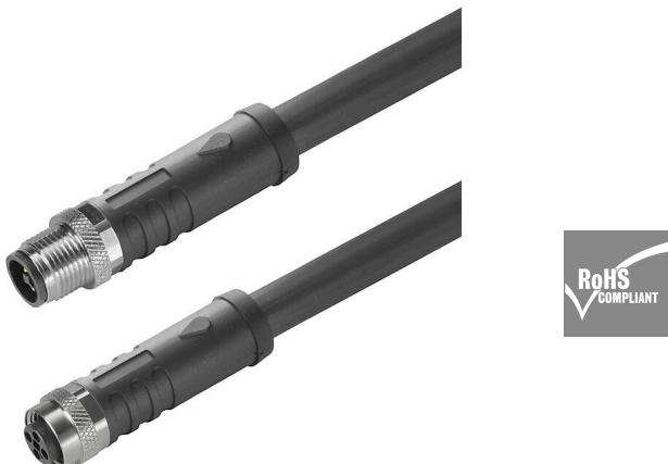
周辺デバイスには、より大きな電力を供給する必要があります。新型 M12 プラグインコネクタを使用すれば、250 V および 2 A 以上を問題なく取り扱えます。小型の A、K、L、S および T コードの M12 プラグインコネクタは、最大 630 V AC または 60 V DC および 12 A の伝送に設計されています。
