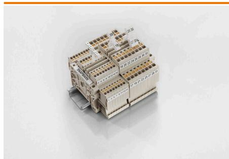
SnapMark - このタグキャリアは、Iモデルシリーズの二段端子 IDK 1.5N に対応して特別に開発されています。柔軟なピボット機構は、渡り配線の容易な取り付け、取り外しを可能にします。4種のDEK 5ラベリングタグ、または2種のWS 10/5 Middleコネクタマーカーを保持できます。
