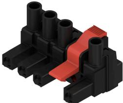
IT 電源ネットワーク対応 7.62 ピッチの 180° メス側プラグ。UL1059 600 V クラスC 適合 オス型ヘッダ SL 7.62 IT との組み合わせリード接点付き。IEC 61800-5-1に準拠したIT電源ネットワークにおける5.5mmタッチセーフティの拡張要件（アース間400V）に適合しています。オプションでねじ止めが可能なセルフロック式ミドルフランジを採用し、従来に比べ 1 ピッチ分のスペース削減を実現しました。
