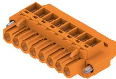
直角 (90° または 270°) の取り出し方向の配線接続対応 クランピングヨーク接続部付属メス側プラグ。メス型コネクタは、マーキングスペースを提供し、コード化できます。フランジまたはリリースラッチによって固定。また、プラス/マイナスネジを搭載し、電線の誤挿入防止構造を備えたクランプヨークは、すぐに電線が接続できるようクランプが開いた状態でお届けします。HC = 高電流。
