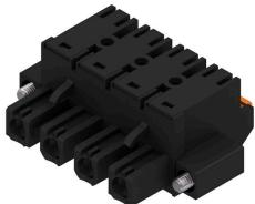
2.5 mm<sup>2</sup>、7.62 ピッチのフィールド配線対応のプッシュイン接続技術採用の 180° メス側ヘッダー。
