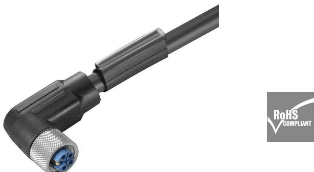
周辺デバイスには、より大きな電力を供給する必要があります。新型 M12 プラグインコネクタを使用すれば、250 V および 2 A 以上を問題なく取り扱えます。小型の A、K、L、S および T コードの M12 プラグインコネクタは、最大 630 V AC または 60 V DC および 12 A の伝送に設計されています。
