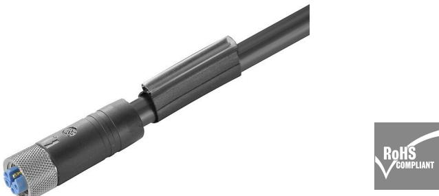
周辺デバイスには、より大きな電力を供給する必要があります。新型 M12 プラグインコネクタを使用すれば、250 V および 2 A 以上を問題なく取り扱えます。小型の A、K、L、S および T コードの M12 プラグインコネクタは、最大 630 V AC または 60 V DC および 12 A の伝送に設計されています。
