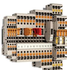
一部の用途では、テストや安全の目的で、テストポイントまたは断路要素をフィードスルー端子に追加することが妥当です。テスト断路端子を使用すれば、無電圧状態で電流回路を測定できます。断路中、空気パスおよびクリープパスの寸法は評価されませんが、指定の定格突入電圧の強度を確認する必要があります。
