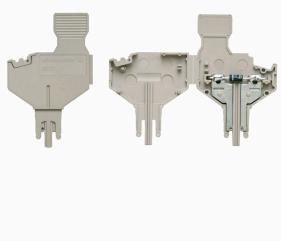
コンポーネントプラグは、電子コンポーネントを接続断路端子台に統合するために使用されます。電子コンポーネントのはんだ付け後、プラグを接続断路端子台の断路箇所に組み込むことで、断路端子台を電子コンポーネント内蔵型のモジューラー端子台に変更します。
