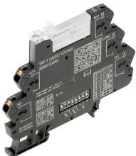
追加機能搭載の制御信号適応対応のタイミングリレー。タイミングリレーは、制御システムやその他装置における高速スイッチングプロセスの調整に使用されます。TERMSERIES TIMER タイミングリレーにはオンディレイがあり、機械のスイッチオンの遅延、システムコンポーネントのカスケード起動、あるいはポンプやバルブなどのユーザー機器の遅延起動を可能にします。それらはまた、One Shot および方向指示機能も備えています。コンパクトな 6.4 mm 端子台形式のTERMSERIES TIMER タイミングリレーは、ネジ接続またはプッシュイン導体接続で使用できます。側面のDIPスイッチを介してタイミング機能と時間範囲を便利に調整することができます。イジェクトレバー上の見やすいデュオ LED により、電源電圧供給と各切り替え状態を一目で確認できます。EN 61812に従った国際認可により、世界中のどこでも使用することができます。TERMSERIES TIMER が幅広いTERMSERIES アクセサリと互換性があることにより、高い柔軟性と既存システムへの容易な統合を実現します。
